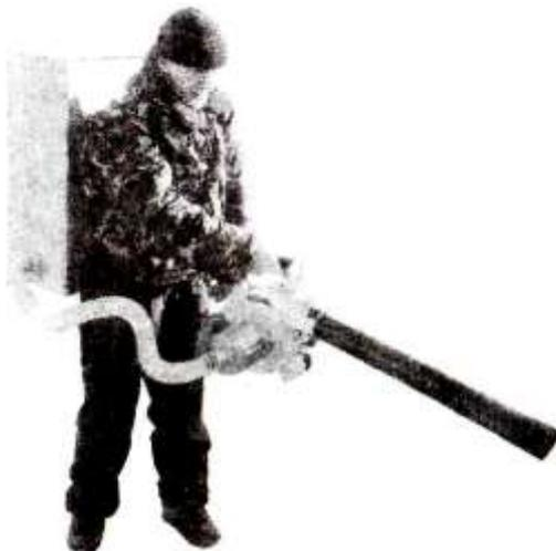
Рисунок 41 – Автономный распылитель сорбента
